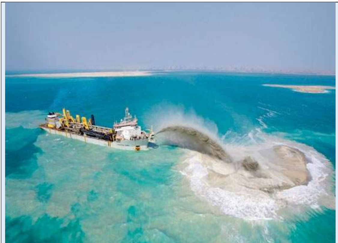
Figura 81. Explotação por dragagem de granulados marinhos (areias) da plataforma continental interna em Dubai .
