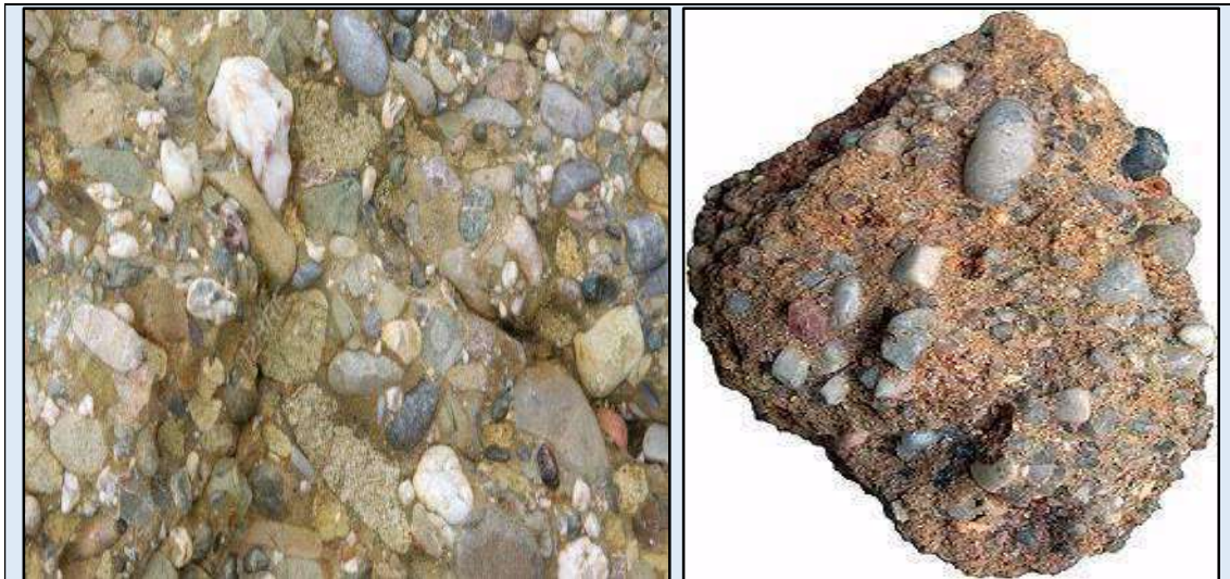
Figura 94. À esquerda, exemplo típico de um ortoconglomerado polimítico ( pudding stone ) e à direita, um paraconglomerado polimítico, ambos com grãos cascalhosos, arredondados e subarredondados de cores diversas e imersos em matriz arenosa. Ambas as rochas são formadas no ambiente de sedimentação fluvial.
