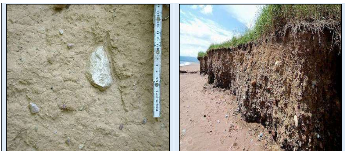
Figura 95. À esquerda, depósito glacial de till , onde os cascalhos aparecem imersos em matriz síltico-arenosa; à direita, corte de afloramento de tilito intemperizado na ilha de cape Breton , adjacente ao golfo de St. Lawrence , no Canadá. Ambas as rochas são formadas no ambiente de sedimentação glacial
